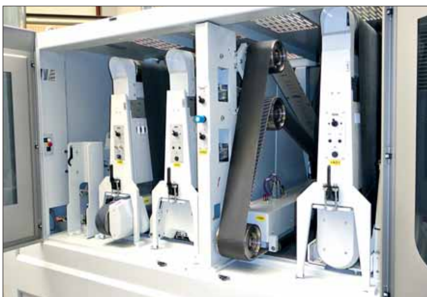
Blick auf das Innenleben der Maschine mit ISA/ISD-Gliederdruckbalken-System
